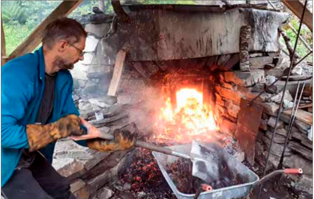
Kvernsteinsparken sitt store prosjekt i 2017 var bygging av ein funksjonell kalkovn etter mellomalderske prinsipp. Kalksteinane vart brennt i 5 døgn og kan så brukast til tradisjonell mørtel. Foto: NKS/MiSF
